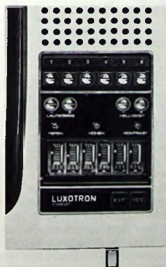
Bedienungsfeld (Abdeckung abgenommen) des Schwarz-Weiß-Fernsehempfängers „Luxotron 116“
