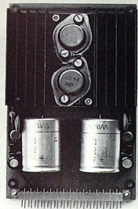
Bild 11. Ansicht der Stromversorgungseinheit
